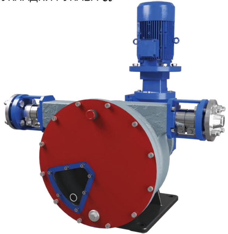
Предназначается для дозирования и перекачивания вязких, абразивных, кристаллизующихся и коррозионных жидкостей, в том числе и эмульсий, содержащих твердые фракции размером до 10% от внутреннего диаметра шланга насоса. Подходит для непрерывных технологических процессов. При работе с агрессивными средами шланги с выходными и входными патрубками обеспечивают стойкость к коррозии, вызываемой перекачиваемой средой.
